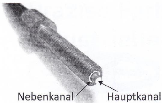
Bild 4: Tastkopf der Faseroptik
