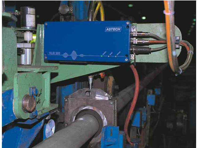
VLM 200 als Geschwindigkeitsmaster für eine Rohrprüflinie, Werk Dinslaken
