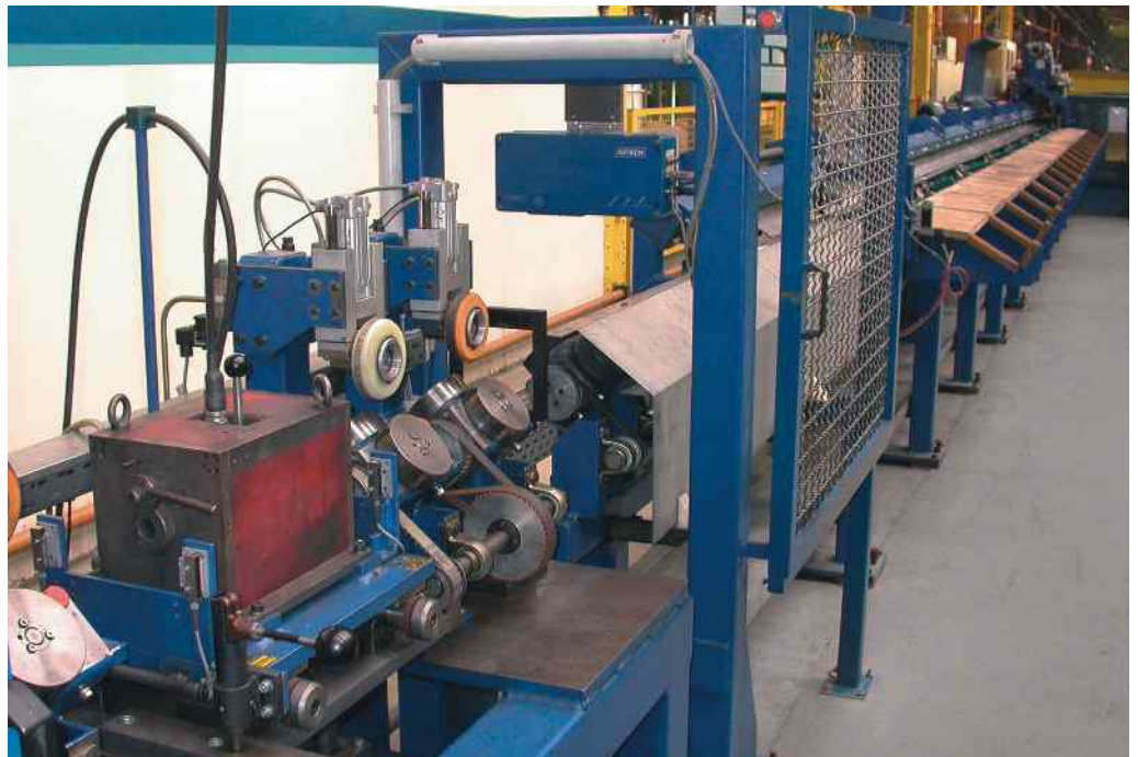
Rohrriecht- und -prüflinie mit VLM 200 FD als Geschwindigkeitsmaster, Werk Paderborn
