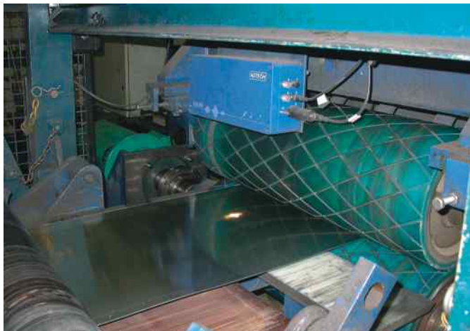
Steuertreiber vor Längsteilschere mit VLM 200, Werk Paderborn
